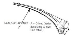
MAXIMUM RECOMMENDED OFFSETS, TO ACHIEVE MINIMUM RADII OF CURVATURE BY BENDING THE BARREL OF 20 ft (6 m) LENGTHS.
