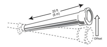
MAXIMUM RECOMMENDED OFFSETS, TO ACHIEVE MINIMUM CURVE RADUIS BY DEFLECTING A STRAIGHT LENGTH OF PIPE AT THE JOINT.
